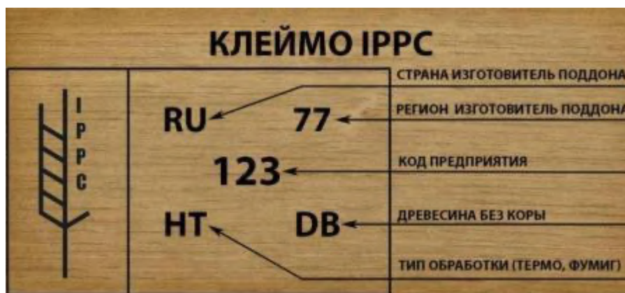
Рис. 39. Маркировка деревянных паллет с клеймом IPPC
