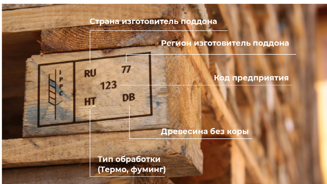
Рис. 23. Образец клейма на палетах
