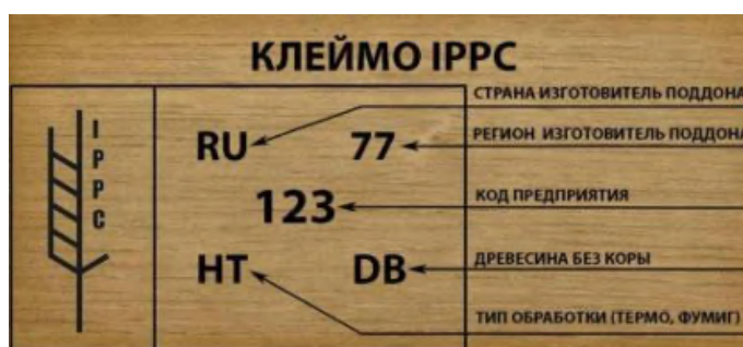
Рис. 19. Образец клейма на палетах
